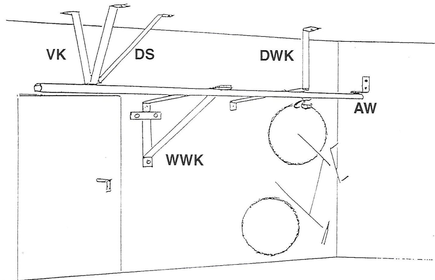
Werden Decke-Wand-Konsole **DWK**, V-Konsolen **VK** oder Wand-Winkel-Konsolen **WWK** montiert, sollte die ganze Konstruktion mit einem Abstütz-Winkel **AW** an einer Seite abgestützt werden. Ist dies nicht möglich, kann mit einer Diagonalstrebe
