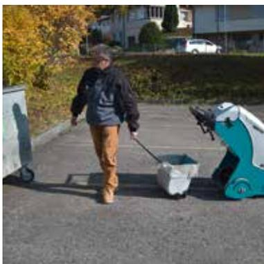
Der Kehrgutbehälter mit Rollen lässt sich leicht entfernen und transportieren.
