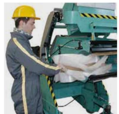
Automatisiertes Hochfahren der gesamten Kehrwalzen-einheit = minimale Wartungskosten.
