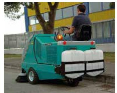
Optional: Zur Staubeindämmung ist eine Wassersprüh-einrichtung erhältlich.
