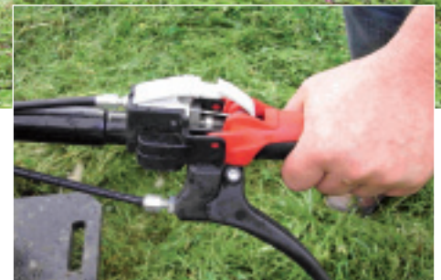
Neuer Totmannschalter zur Trennung von Fahr- und Zapfwellenantrieb, Motor läuft weiter.
