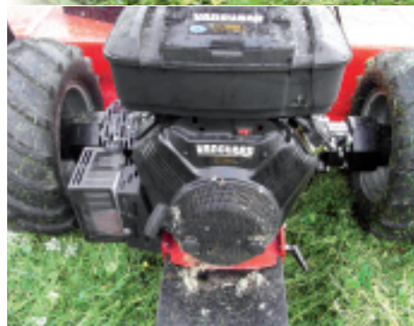
Der 2-Zylindermotor von Briggs&Stratton ist derzeit mit 18,2 PS die stärkste Motorisierungsvariante.
