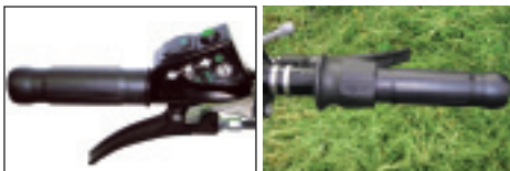
Zwei neue Geschwindigkeitsregelungen: (1) Elektrisch, oder (2) verbesserte Drehgriffsteuerung.
