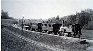
Dampfzug, bespannt mit der 3/3-gekuppelte Tenderlokomotive «Albis»; gebaut 1875, ausrangiert 1922
