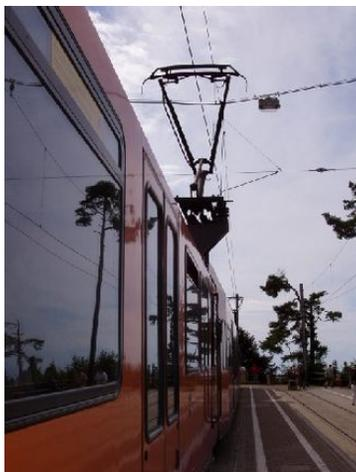
Seitlich versetzter Stromabnehmer eines Triebwagens der Uetlibergbahn
