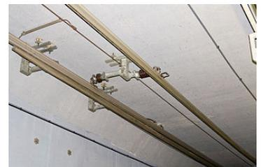
Gemeinsame Deckenstromschienen der Uetlibergbahn (links) und Sihltalbahn (rechts) über demselben Gleis, im Tunnel am Zürcher Hauptbahnhof
