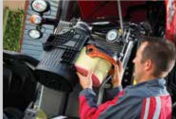
Die Kühler können zum Reinigen nach vorn geklappt werden und sind gut mit einem Druckluftschlauch zu erreichen.
