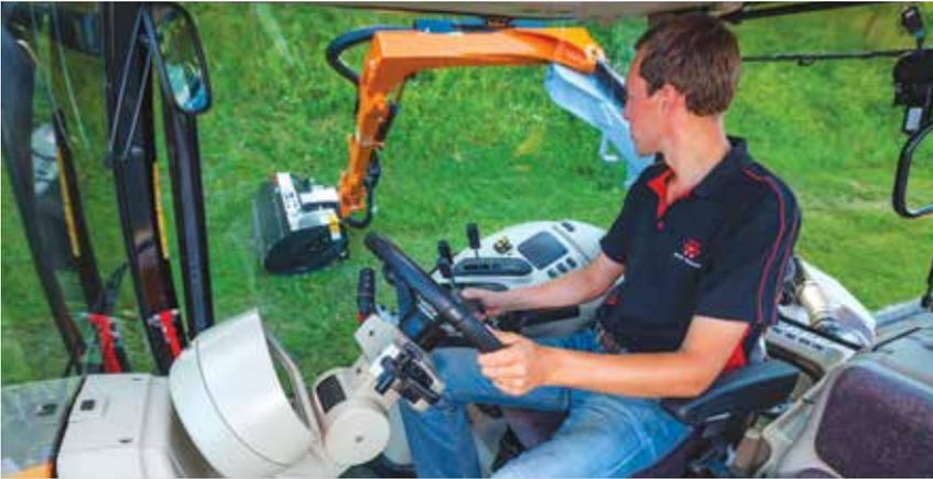
Die Panorama-Kabine der Baureihe MF 6600 bietet eine ungehinderte Sicht nach rechts für das sichere und effiziente Arbeiten mit seitlich montierten Anbaugeräten. Die breite einteilige Polycarbonatscheibe ist extrem stabil und schützt den Fahrer vor hochgeschleuderten Steinen und Geröll.
