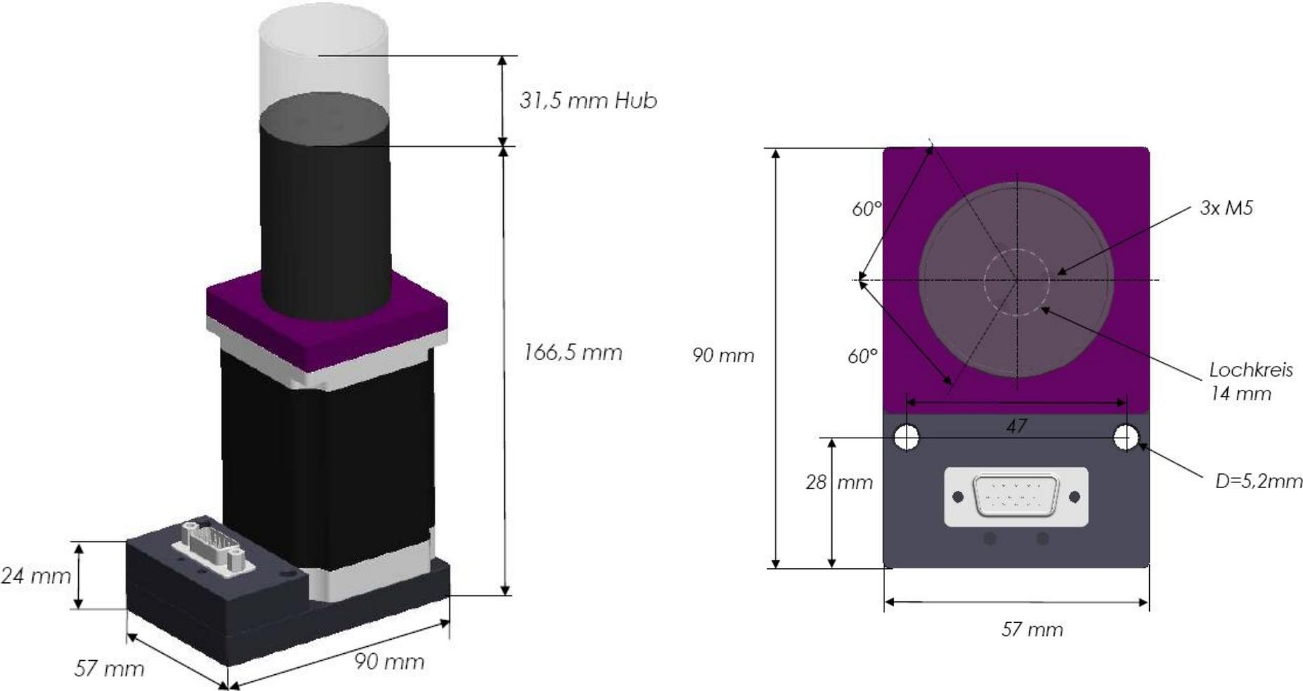
Die Abmessungen sind bei uns als CAD Dateien in folgenden Formaten verfügbar: **\*.vda, \*.igs, \*.prt**
