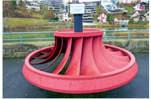
Bild 15: Laufrad einer Francis-Turbine
