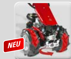
Die Köppel Turnaround-Aktivlenkung dreht das Motorgerät direkt über den Mittelpunkt um 180° auf der Stelle. Die Radmotoren werden einzeln gegenläufig angetrieben und sorgen für volle Kontrolle bei der Wende mit minimalem Kraftaufwand und maximaler Schonung des Untergrunds.
