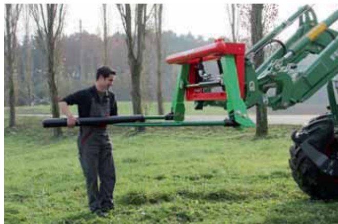
BALLENGABEL BG 180 DEMONTAGE VOM BALLENROHR AUF STROHSPIESS
