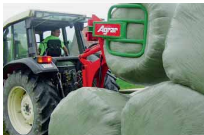
BALLENZANGE BZ 160 MIT STAPELRAHMEN (STAPELHÖHE BIS 1.4 METER)
