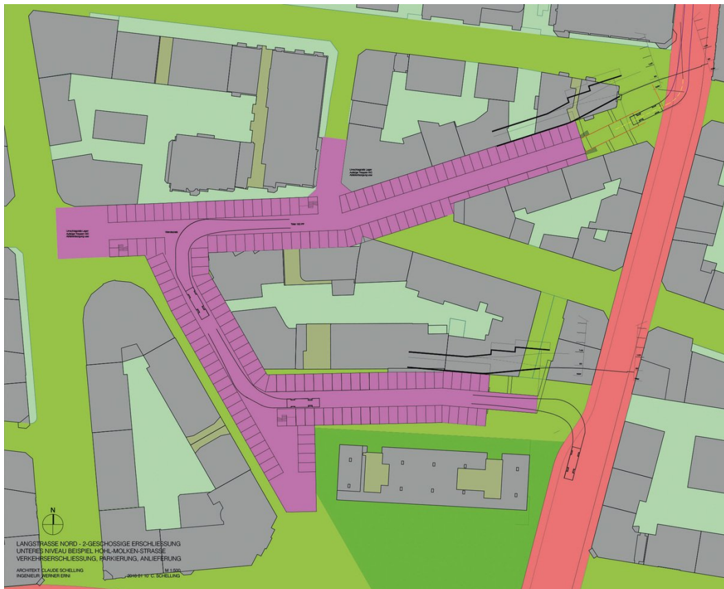
Zwei Rampen, drei Treppen: unterirdische Strasse beim Helvetiaplatz. Bild: Claude Schelling/ERZ
