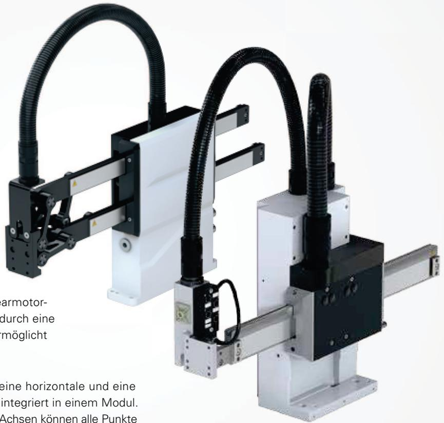
Pick & Place HP 70: zwei horizontale Linearmotorachsen parallel übereinander, verbunden durch eine kinematische Einheit. Die Konstruktion ermöglicht eine Modulbreite von 60mm.
