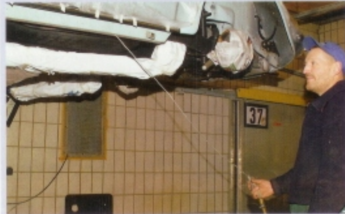
Der Geheimagent im Einsatz: Die biegsame Bremsleitung lässt sich problemlos durch den ganzen Schweller schieben. Auf diese Weise lässt sich der Hohlraum auch sauber und trocken blasen
