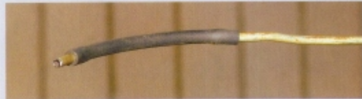
Der fladdert und fladdert und pustet sich oft: Mike Sanders verdeckter Rostklopfer besteht aus einer Druckluftpistole, zwei Meter Bremsleitung, einem Stück Schlauch und einem kurzen Stück Drahtleitung
