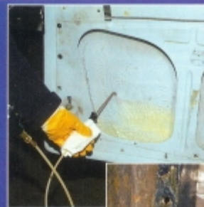
Ein etwa 20 Zentimeter hoher Fettstreifen reicht nach Sanders Erfahrungen völlig aus, um eine Tür zuverlässig zu schützen. Auch hier ist die Hebeldüse das richtige Werkzeug.
