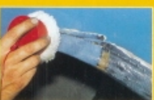
Schwamm drüber: Schneller Zink aus der Bordsteckdose
