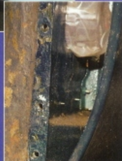
Das Fett in diesem Hohlraum ist nach 10 Jahren alt und noch immer weich und fleisbig!
