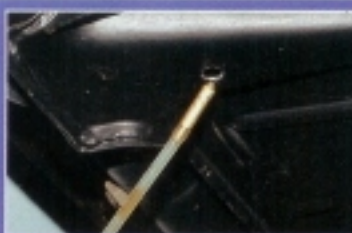
Das gebohrte Loch muss so groß sein, dass sich die Sonde darin schräg stellen lässt.
