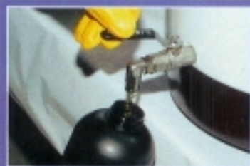
Der Bechor der Spritzpistole ist ebenfalls vorgeheizt, damit das Fett nicht zähflüssig wird.
