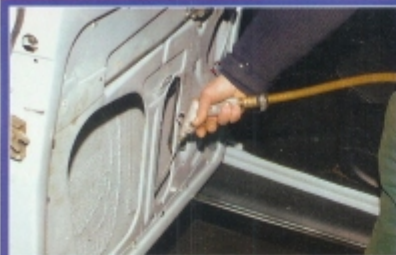
Nachdem die Verklebung der Tür entfernt ist, wird das Innere gründlich mit dem Sprühsauger gereinigt und mit Druckluft sauber geblasen.
