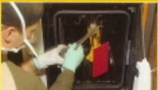
Pulverbeschichten: Haltbarer Schutz für Fahrwerksteile
