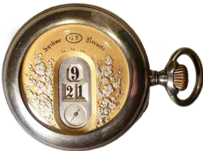
Wo die Digitalanzeige «springt»: Springeruhr Gédéon Thommen, patentiert 1885
