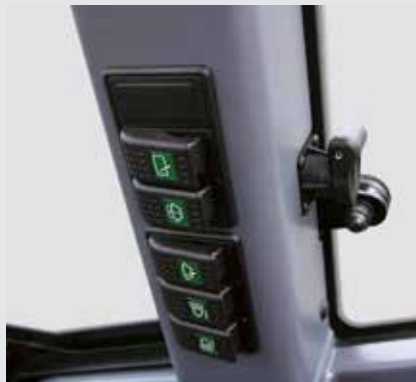
Zusammengefasste Schalterleiste, Steckdose mit Dauerstrom
