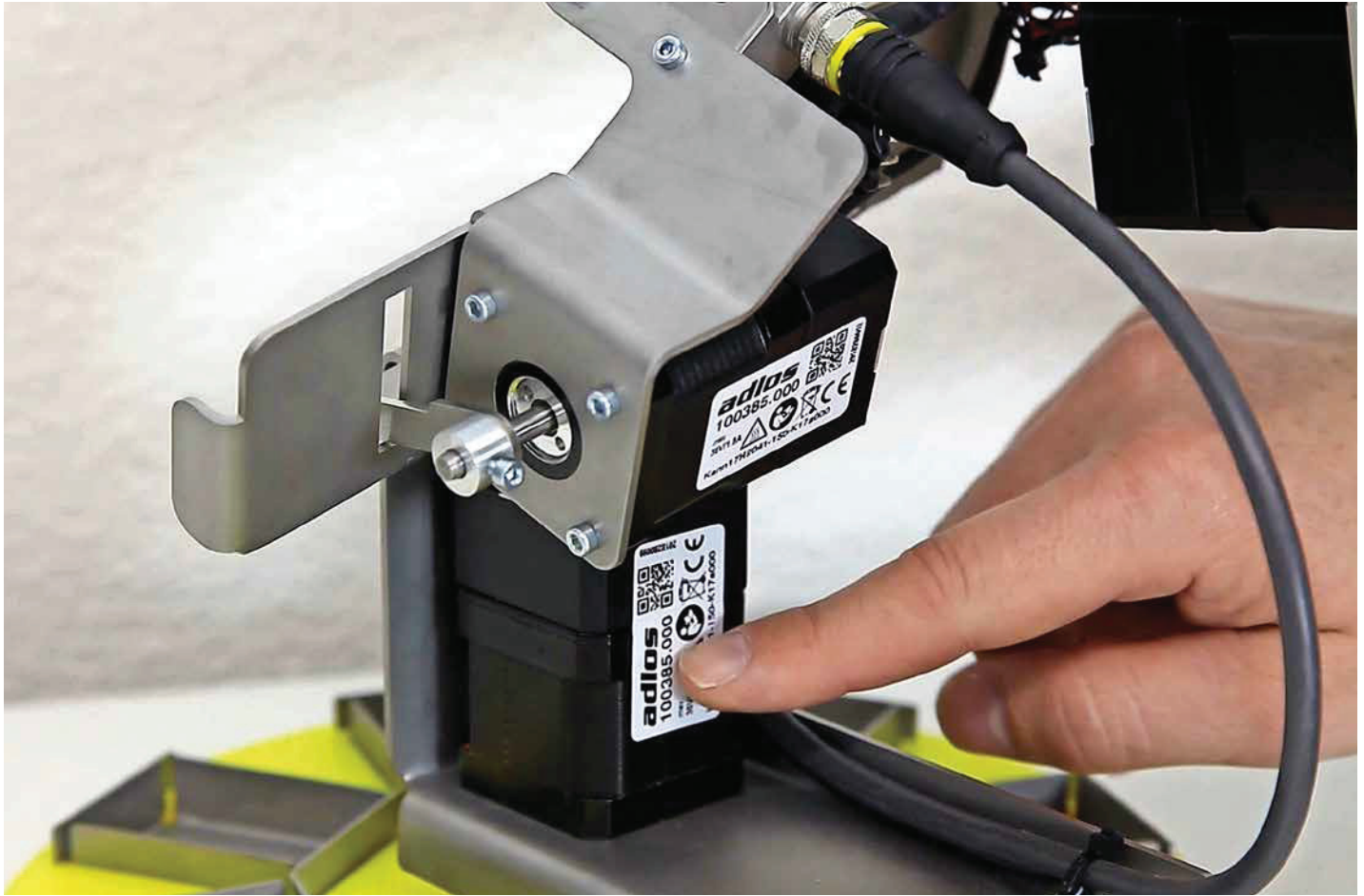
Münzsortierer: Rückansicht vom Drehtellermotor und dem Freigabemotor
