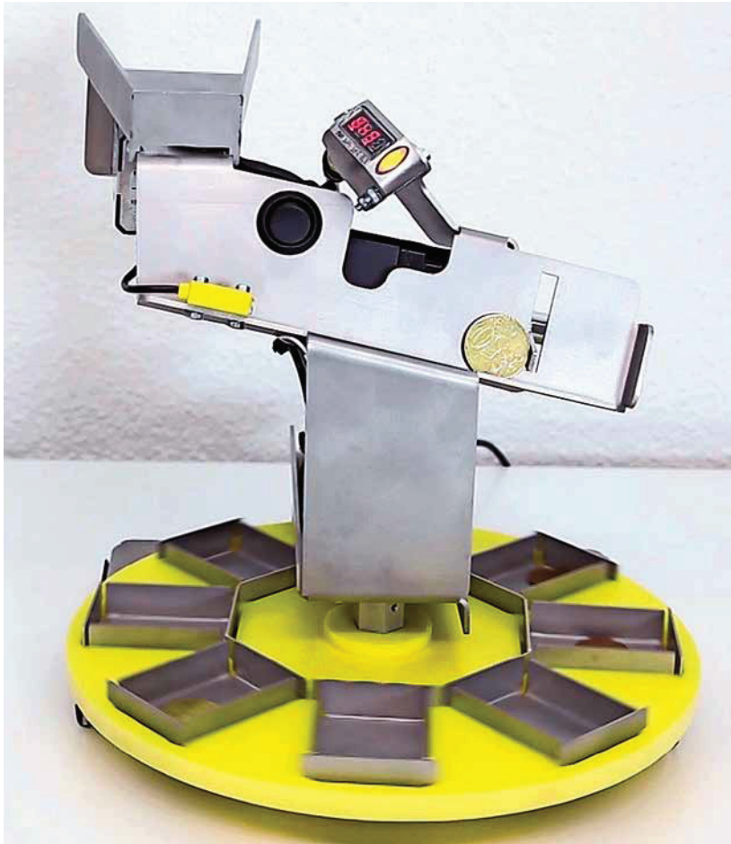
Der Münzsortierer veranschaulicht, dass sich mit dem KannMotion auch ohne SPS eine komplexe Anwendung umsetzen lässt.
