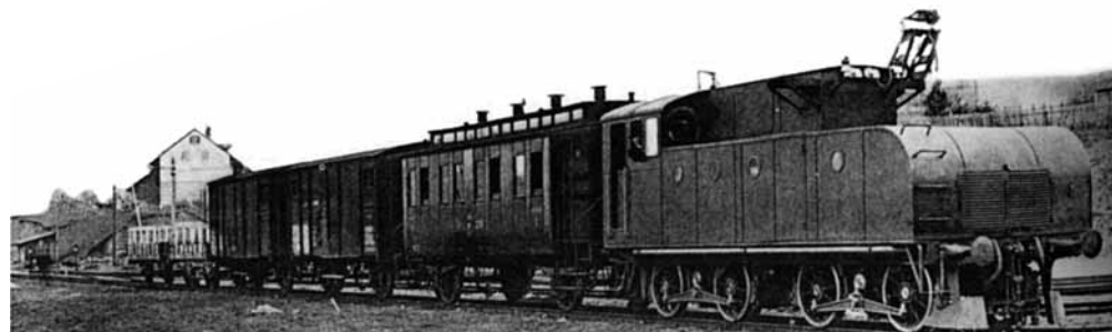
Zug mit Einphasenwechselstrom-Lokomotive (genannt «Eva») in Seebach im Jahre 1904.
