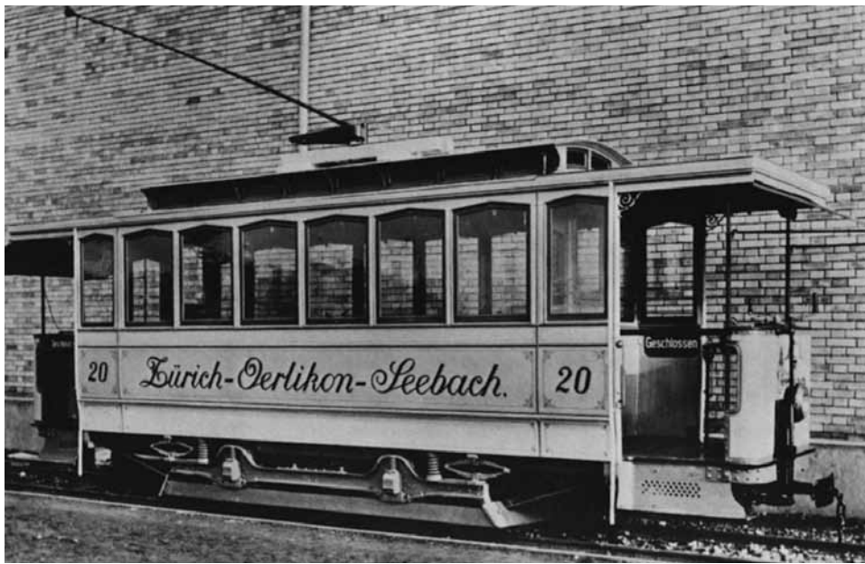
ZOS-Motorwagen Nr. 20, Baujahr 1899: Originalzustand ohne Plattformverkleidung
