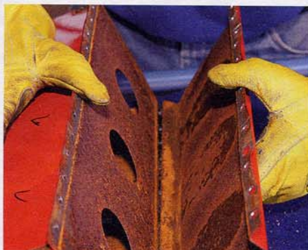
...der „Innenschweller“ abnehmen. Erste Einblicke zeigen: jede Menge Rost
