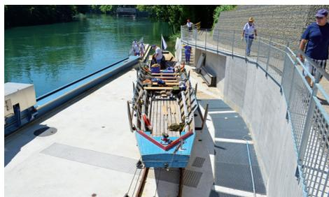
*Bild 15: Transportwagen mit 15 m Langschiff*
