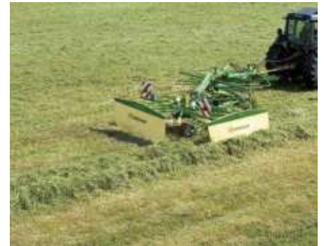
Doppelschwadablage Ein Doppelschwad aus 12,40 m
