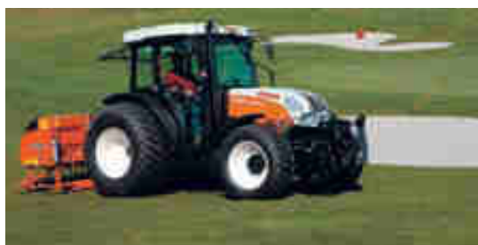
1 Exakte bodenangepasste Führung mit dem achsgeführten Fronthubwerk
