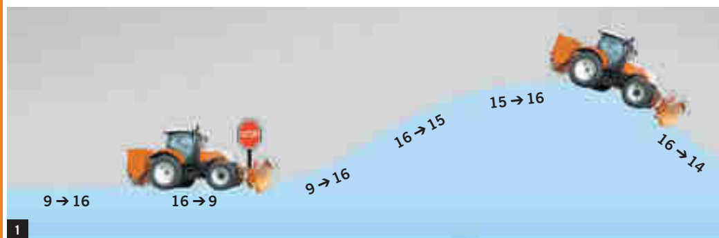
1 Steyr Matik. Automatisches Hoch- und Herunterschalten beim Transport und Mäheinsatz.
