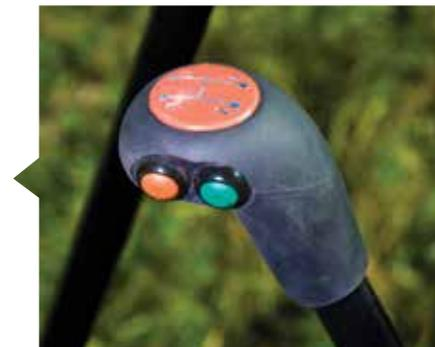
Die ergonomisch am Schalthebel angeordnete SpeedShift-Bedientaste vereinfacht dem Fahrer die Bedienung in der Kabine. Am Schalthebel befindet sich zudem die Taste zum Auskuppeln, die zum manuellen Gangwechsel oder beim Anfahren oder Anhalten des Traktors verwendet werden kann.
