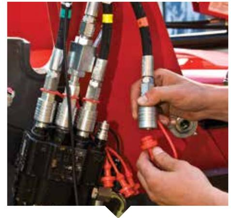
04. Hydraulische Verbindungen trennen.
