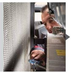
Die kompakte Kühleinheit ist bequem zugänglich und einfach zu reinigen und zu warten. Durch die Saugwirkung der Kühlgebläse wird der Staub zu 90 % von selbst entfernt. Auch der Luftfilter des Motors ist bequem zugänglich und leicht zu reinigen.
