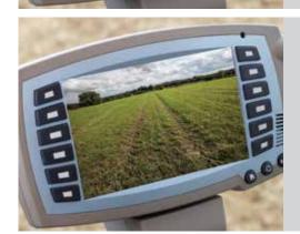
Video-Modus – Bilder einer Bordkamera können auf dem Bildschirm der Konsole dargestellt werden. Diese kann der Fahrer nutzen, um den Einsatz komplexer Arbeitsgeräte zu überwachen oder, um die Sicherheit und Schnelligkeit beim Rückwärtsfahren zu erhöhen.
