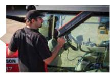
Der Kabinenluftfilter kann zur Reinigung einfach entnommen werden.
