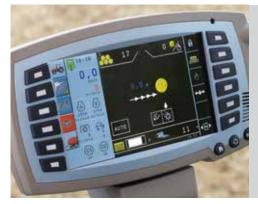
Durch den ISOBUS können die Bedienmasken eines Arbeitsgeräteherstellers auf dem Bildschirm der Konsole dargestellt werden. Besitzer und Fahrer sparen dadurch Zeit und Geld, da in der Kabine keine zusätzlichen Terminals installiert werden müssen. Verbinden Sie einfach das Anschlusskabel des Arbeitsgeräts mit dem ISOBUS-Anschluss des Traktors und das System lädt automatisch die Bedienmasken und zeit ein auf dem Bildschirm an
