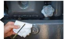
Die schlanke Bauweise von Motorhaube und Vorderachse garantiert den bequemen Zugang zu Motorölfiltern und Ölmessstab.
