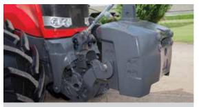
Die intelligente Bauweise des geschwungenen Rahmens und des integrierten Fronthubwerks ermöglichen eine exzellente Wendigkeit und große Lenkeinschläge.
