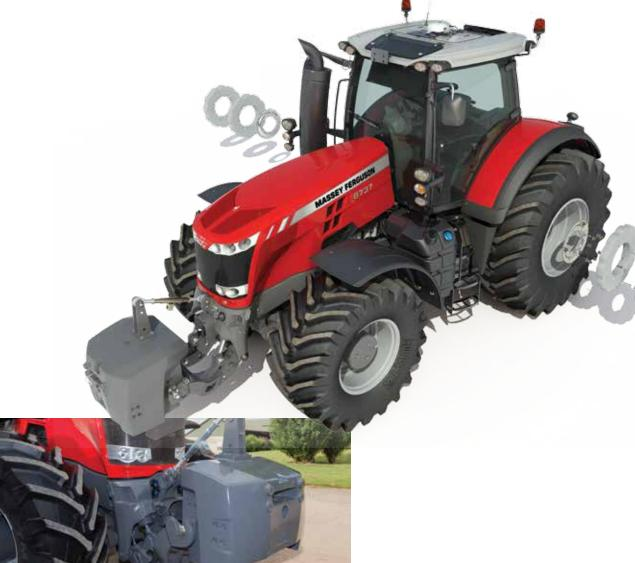
Große Ballastauswahl verfügbar. Manchmal brauchen Sie zusätzliches Gewicht für traktionsintensive Arbeiten. Der MF 8700 kann werkseitig oder über AGCO Parts mit zusätzlichen Front-, Heck- und Reifengewichten genau an Ihre Anforderungen angepasst werden. Das Angebot beinhaltet werkseitig neu entwickelte 1.450-kg- und 2.300 kg Ballastlösungen mit Aufnahmemöglichkeit für weitere Zusatzgewichte, beidseitig 250- bis 750-kg-Radballast sowie einem Frontblockgewicht.
