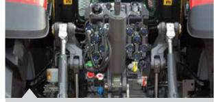
Alle Heckkupplungen sind mit hydraulischer Druckentlastung ausgestattet.
