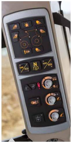
Bedienelemente für Zapfwellendrehzahl und Hubwerksteuerung an der Kabinensäule.
