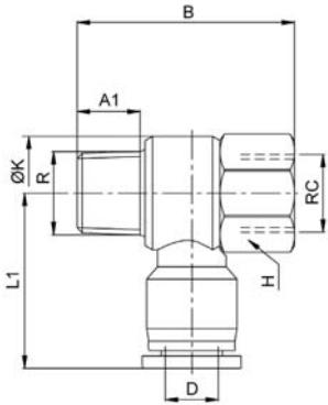
**CODE TB15FC** Steck-Winkelverschraubung mit Innengewinde, teflonisiert
