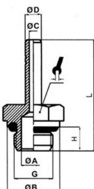
**CODE TB06** Stecker mit Außengewinde (Kurz) mit O-Ring
