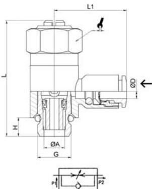
**CODE TB28** Steck-Drosselrückschlagventil ZULUFT
