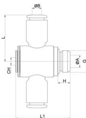
**CODE TB16** T-Steckverschraubung mit Innensechskant und O-Ring
