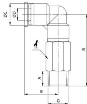
**CODE TB22LC** Steck-Winkelverschraubung lang, teflonisiert
