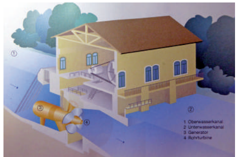
Bild 12: Übersicht BBC-Rohrturbine, ab 1987 im KW
