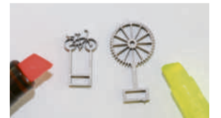
«Jööh!» darf frau nur denken ... Techniker wollen anderes hören: «Unglaublich, diese filigrane Präzision dank Mikrowasserstrahl!» sm
