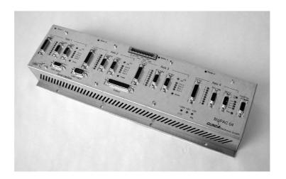
Die Geräte der BigPAC-Serie sind komplette Steuerungen für vier Schrittmotore, die an der Maschine, direkt neben dem Motor oder im Schaltschrank montiert werden können. Sie enthalten eine programmierbare Positioniersteuerung mit Programmspeicher, Leistungsendstufe, div. Einund Ausgänge und verschiedene Schnittstellen für unterschiedliche Bedienoberflächen.
