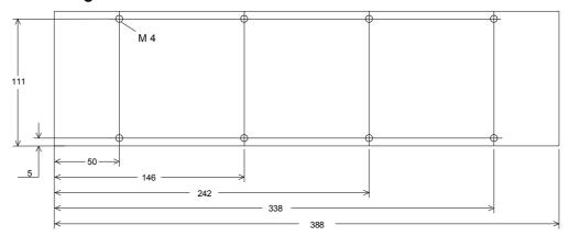
Das Gerät wird mit acht M4-Schrauben gemäß oberer Zeichnung befestigt. An der Unterseite ist eine Wärmeleitfolie angebracht, die für eine optimale Wärmeübertragung sorgt.
