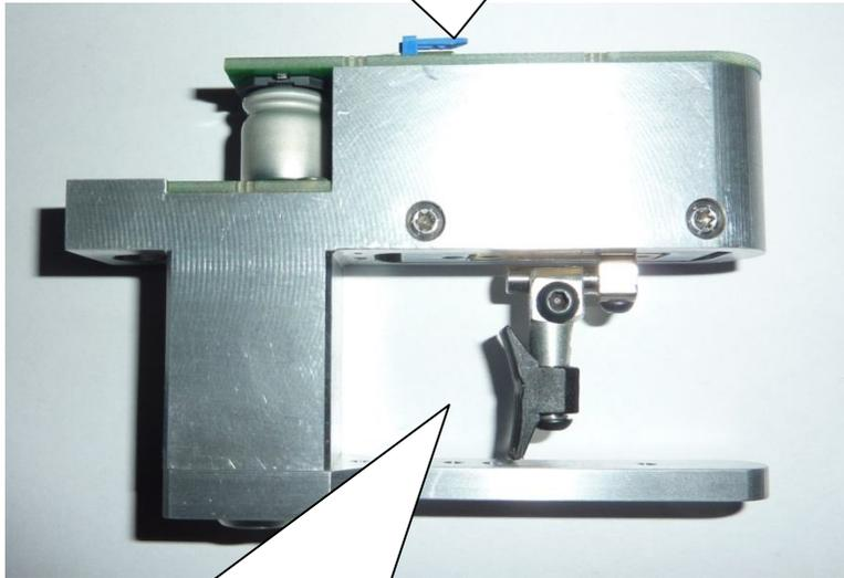
Mit der Betätigung der Abzugszunge wird die Elektronik aktiviert
