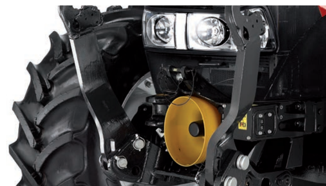
Integrierte Fronthydraulik mit 1.670 kg Hubkraft (Farmall 85 bis 115 C)
