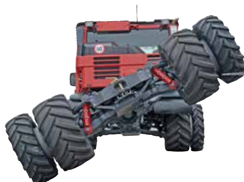
Hinterwagen in extremer Verdrehung zur Kabine (max. +/- 30°)
